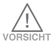
Dieses Symbol in Verbindung mit dem Signalwort "Vorsicht" kennzeichnet eine möglicherweise gefährliche Situation. Die Nichtbeachtung dieses Sicherheitshinweises kann zu leichten oder mittelschweren Verletzungen führen.
